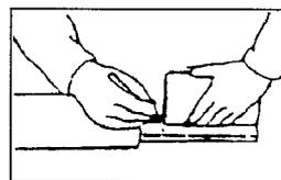
(3) パイプのアウトとインナ両方を金ノコまたはカッターで切断します。
