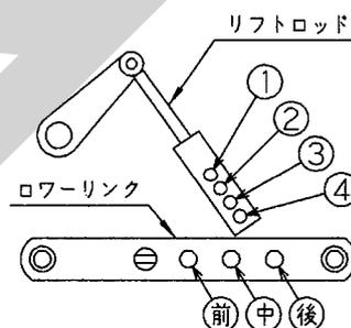
3点リンク最上時、シャッタ開閉レバーがトラクタに干渉するものがあります。純正ロータリー用ヒッチ以外で本作業機を装着する場合は、リフトロッド穴を4（最下）、ロワーリンク穴を後で装着してください。
