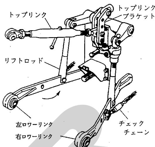
特殊3点リンク式のロータリーを使用している場合には、トップリンクの連結部を外し、標準3点リンク用の長いトップリンクを使用してください。
