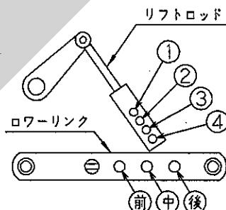
3点リンク最上時、シャッタ開閉レバーがトラクタに干渉するものがあります。純正ロータリ用ヒッチ以外で本作業機を装着する場合は、リフトロッド穴を4（最下）、ローワーリンク穴を後で装着してください。
