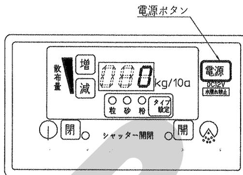
(4) 車速連動のプログラムに戻すには、電源を切った状態で(1)、(2)の操作を再度行ってください。
