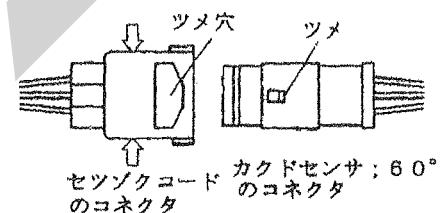
(6) セツゾクコードの2Pコネクタ（T字、コード色 白・黒）をコード；3500（電源コード）又はトラクタ内の電源に取付けてください。
