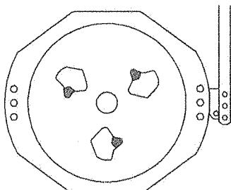
レバースイッチを「停止」側に倒し、全ての落下口が塞がるまでシャッターを閉じてください。
