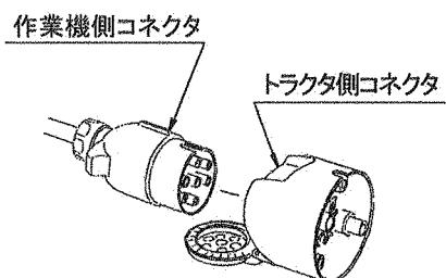
又、トラクタ側の外部電装品取出し口が6Pコネクタ（オスコネクタ、メスコネクタ）、8Pコネクタで装備されている場合は、オプション品の中間ハーネス（1172730000）を使用して接続してください。
