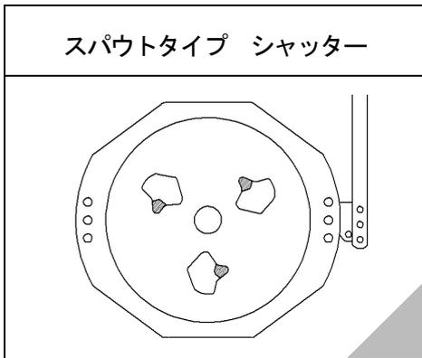
レバースイッチを「停止」側に倒し、全ての落下口が塞がるまでシャッターを閉じてください。
