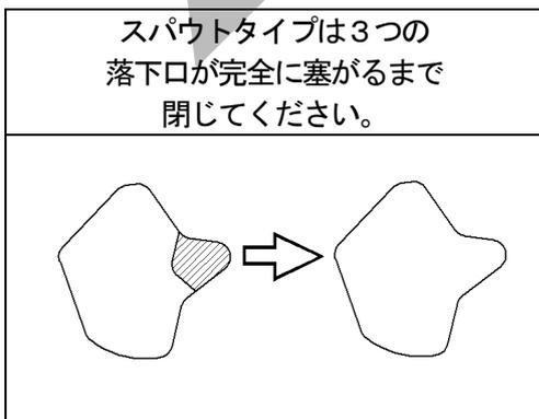
※落下口が閉じきらない場合は、シャッターとレバーのリンク長さを調整してください。
