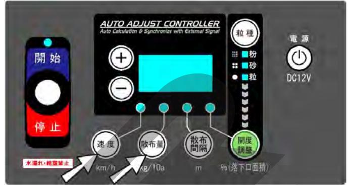
※表示されている数値が「96～196」の範囲で速度ランプと散布量ランプが点灯します。その範囲で落下口が閉じきらない場合は、シャッターとレバーのリンク長さを調整してください。
