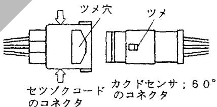
(6) セツゾクコードの2Pコネクタ (T字、コード色 白・黒) をコード ; 3500 (電源コード) 又は トラクタ内の電源に取付けてください。
