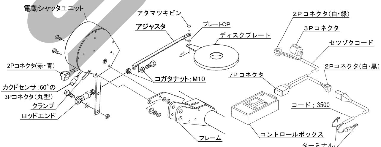
(2) 電動シャッタユニットをフレームにボルト、ヒラザガネ、バネザガネ、コガタナット；M10で固定してください。
