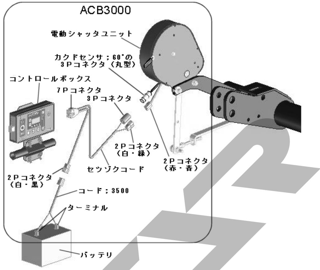
(4) コード ; 3500 (電源コード) をバッテリターミナルへ取付けてください。(トラクタ運転席に電源がある場合は、電源コードは不要です。) コード ; 3500 (電源コード) のターミナルは、バッテリターミナルを止めているボルトと共に締めにしますので、バッテリから $\ominus$ 、 $\oplus$ 共にコードを外してください。
