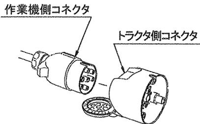
又、トラクタ側の外部電装品取出口が 6Pコネクタ (オスコネクタ, メスコネクタ), 8Pコネクタで装備されている場合は、オプション品の中間ハーネス (1172730000) を使用して接続してください。
