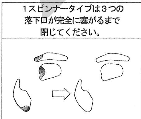
※落下口が閉じきらない場合は、シャッターとレバーのリンク長さを調整してください。
