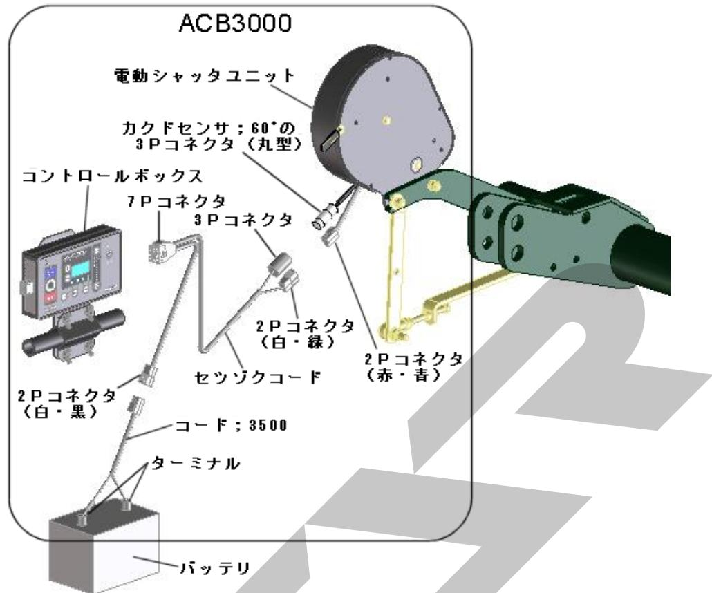
(4) コード；3500（電源コード）をバッテリターミナルへ取付けてください。（トラクタ運転席に電源がある場合は、電源コードは不要です。）コード；3500（電源コード）のターミナルは、バッテリターミナルを止めているボルトと共に締めにしますので、バッテリから□、□共にコードを外してください。
