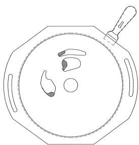
レバースイッチを「停止」側に倒し、全ての落下口が塞がるまでシャッターを閉じてください。
