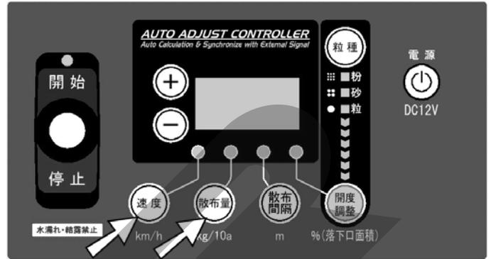
※表示されている数値が「96～196」の範囲で速度ランプと散布量ランプが点灯します。
