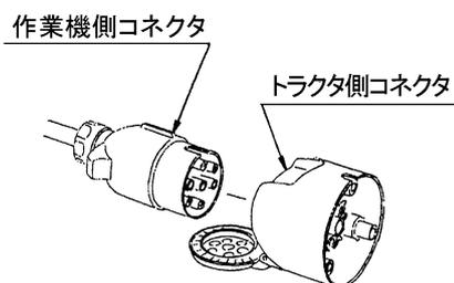
又、トラクタ側の外部電装品取出口が 6P コネクタ (オスコネクタ, メスコネクタ), 8P コネクタで装備されている場合は、オプション品の中間ハーネス (1172730000) を使用して接続してください。
