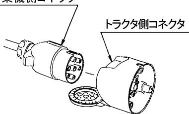
又、トラクタ側の外部電装品取出し口が6Pコネクタ（オスコネクタ、メスコネクタ）、8Pコネクタで装備されている場合は、オプション品の中間ハーネス(1172730000)を使用して接続してください。
