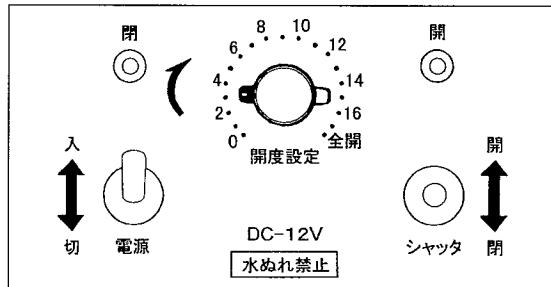
(3) 開閉スイッチを「開」にします。このときチェックランプの「開」が点滅しシャッターが設定された開度まで開きます。開度が全開で動作が完了した時は、チェックランプの「開」が点灯します。
