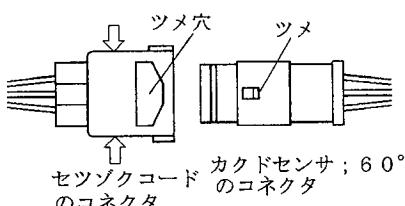
(7) セツゾクコードの2Pコネクタ（T字、コード色 白・黒）をコード；3500（電源コード）又はトラクタ内の電源に取付けて下さい。
