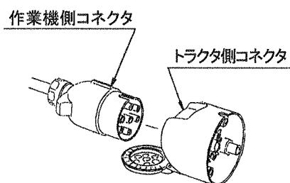
又、トラクタ側の外部電装品取り口が6Pコネクタ（オスコネクタ、メスコネクタ）、8Pコネクタで装備されている場合は、オプション品の中間ハーネス（1172730000）を使用して接続してください。
