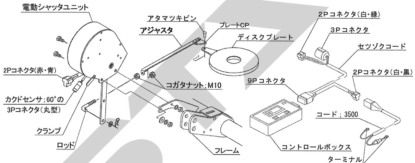
(1) 電動シャッタユニットをフレームにボルト、バネザガネ、コガタナット；M10で固定してください。
