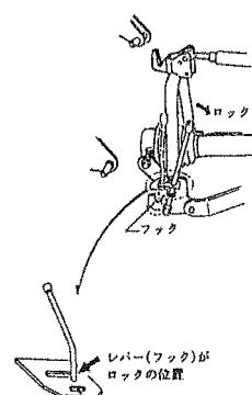
(10) P I C軸芯がトラクタ中心におおよそ一致するようチェックチェーンでセットしてブロードキャスターの横振れをなくしてください。
