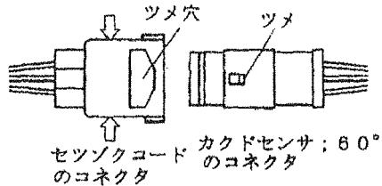
(6) セツヅクコードの 2P コネクタ (T字、コード色 白・黒) をコード ; 3500 (電源コード) 又はトラクタ内 の電源に取付けてください。
