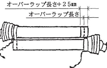
(5) 3点リンクを昇降させて、PTO軸とPIC軸が最も離れる位置で、昇降を停止してください。
