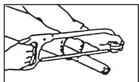
切断するときは、パイプの中にウエスを詰め、パイプ内面に切り粉が付着するのを防いでください。
