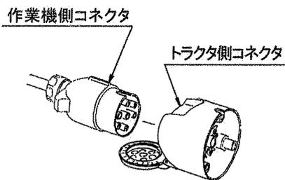
又、トラクタ側の外部電装品取出口が 6Pコネクタ (オスコネクタ, メスコネクタ), 8Pコネクタで装備されている場合は、オプション品の間中ハーネス (1172730000) を使用して接続してください。
