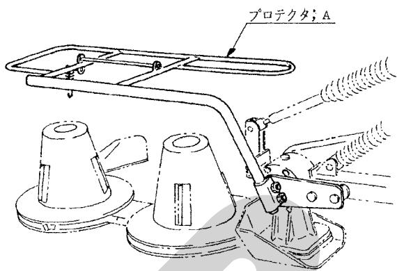
(6) プロテクタ；Bをプロテクタ；Aにピン(ワリピン、ワッシャ付)で取付け、スプリングをかけてください。
