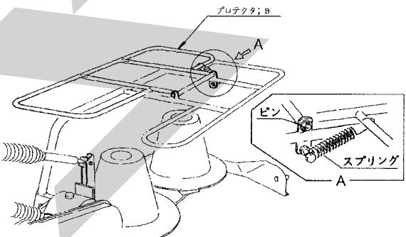
(7) プロテクタにプロテクタキャンバスをかぶせ、バンドで締付けてください。
