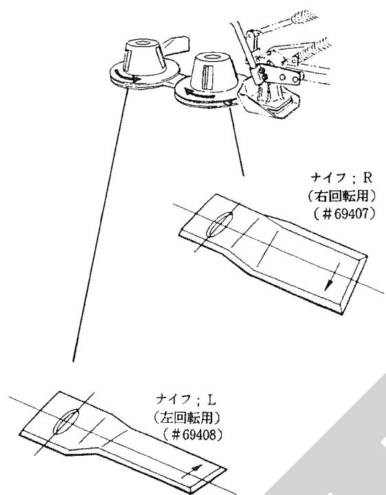
ナイフボルト、ナイロンナットを締付ける時はディスクに回り止めを当て、締付けトルク $50\text{N}\cdot\text{m}$  ( $=500\text{kgf}\cdot\text{cm}$ ) でしっかり締付けてください。
