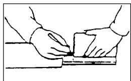
(3) パイプのアウタとインナ両方を金ノコまたはカッターで切断します。
