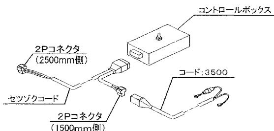
(4) セツゾクコードの1500mm側（短い方）のコネクタを、コード；3500（電源コード）のコネクタに取付けてください。
