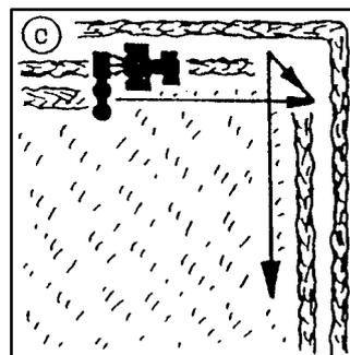
(4) ほ場の枕地で旋回するときは、トラクタの3点リンクを上昇し作業機を持ち上げて行ってください。
