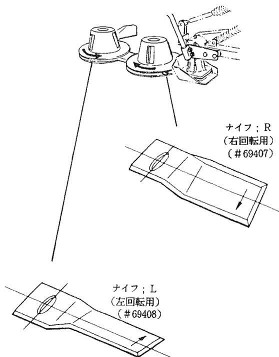
ナイフボルト、ナイロンナットを締付けるときはディスクに回り止めを当て、締付けトルク  $50\text{N}\cdot\text{m}$  ( $=500\text{kgf}\cdot\text{cm}$ ) でしっかり締付けてください。
