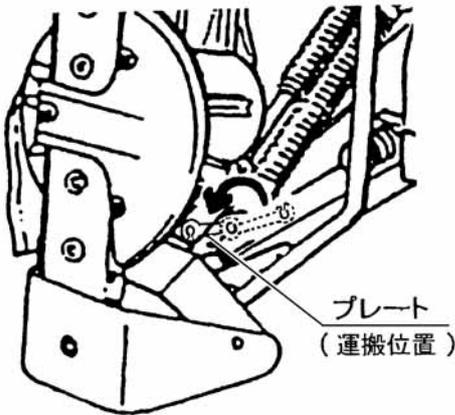
5. トラクタの3点リンクの降下を防止して、移動を開始してください。
