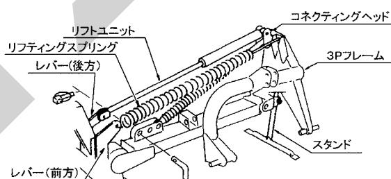
5. トラクタの3点リンクの下降を防止して、移動を開始してください。
