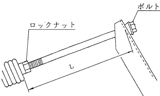
(2) 土手などののり面でカッタバーを水平位置から30°以上下向きにして作業する時は、上記標準寸法より50～100mm長くなるよう調整してください。
