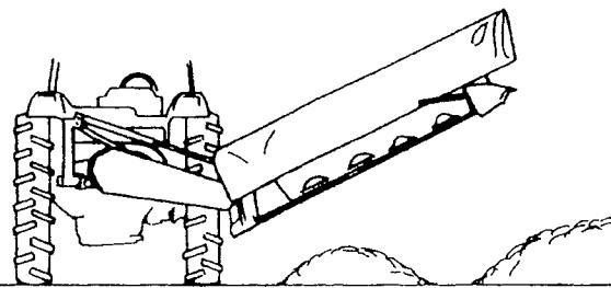
③ MDM2150、2450の場合は、外部油圧レバーを操作し、カッタバーを水平位置から上向きに上昇してください。
