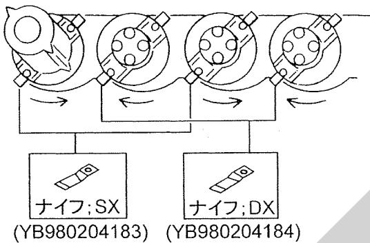
ナイフボルト、ナットを締付ける時はディスクに回り止めを当て、締付けトルク110~127N·m (=1,100~1,270kg·cm) でしっかり締付けてください。
