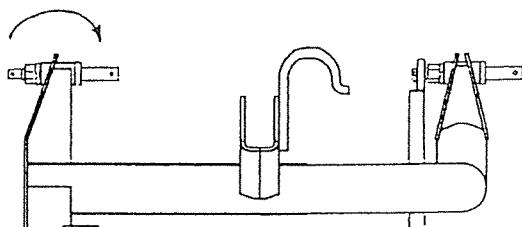
(5) 作業機の3Pフレームをトラクタ3点リンクで持ち上げた時、3Pフレームがほぼ垂直に上がるよう作業機のトップリンクピン穴位置を選んでトップリンクを連結し、抜けどめに作業機についているベータピンを差してください。
