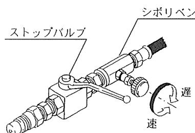
(1) トラクタ外部油圧取出口のカプラに作業機のカプラを接続してください。
