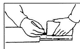
(3) パイプのアウタとインナ両方を金ノコ又はカッターで切断します。
