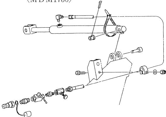
④ カッタバーを地面に置いた状態で3Pフレームを持ち上げ、リフトユニットをレバー（後方）に取付けてください。
