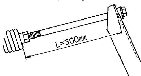
⑥ リフトブラケットにプロテクタフレームを取付けてください。
