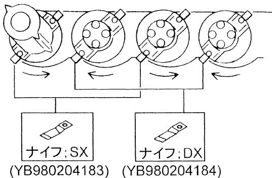
ナイフボルト、ナットを締付けるときはディスクに回り止めを当て、締付けトルク110～127 N・m (=1,100～1,270kg・cm) でしっかり締付けてください。
