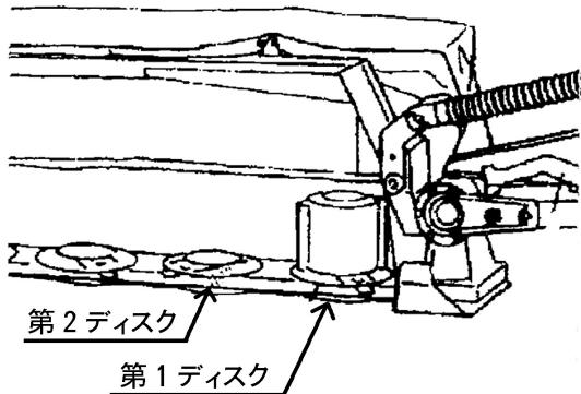
第1、2ディスクにショートナイフを取り付けた場合、他のディスクと刈高さに若干の違い（段差）が生じますので全ディスクを回転方向に合わせ交換することもできます。
