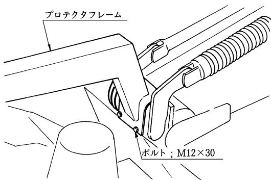
⑦ プロテクタフレームにプロテクタを付け、スプリングをかけてください。後方のプロテクタはデルタピンで固定してください。
