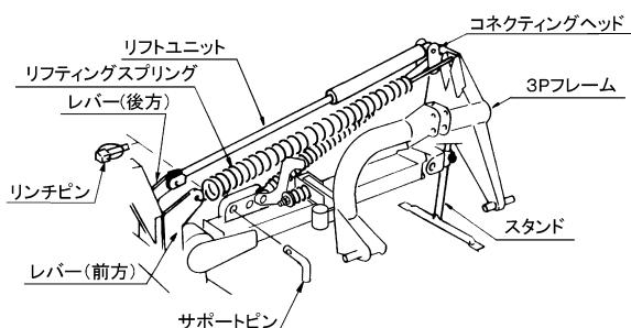
⑤ 3Pフレーム及びレバー（前方）にリフティングスプリングを取り付けてください。取付け寸法は、3Pフレームの取付け部からリフティングスプリングまでの長さをL=300mmにしてください。
