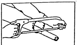
切斷する時は、パイプの中にウエスを詰め、パイプの内面に切り粉が付着するのを防いでください。
