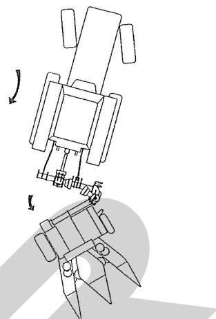
(3) 本体と3点フレームが90°開いたら、トラクタの外部油圧を旋回用シリンダが伸びる方向に操作しながら、サイド状態になるまでバックします。
