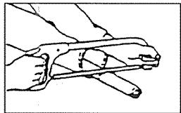
切断する時は、パイプの中にウエスを詰め、パイプの内面に切り粉が付着するのを防いでください。
