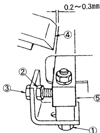
**3. ナイフとボトムプレートの間隔調整**
