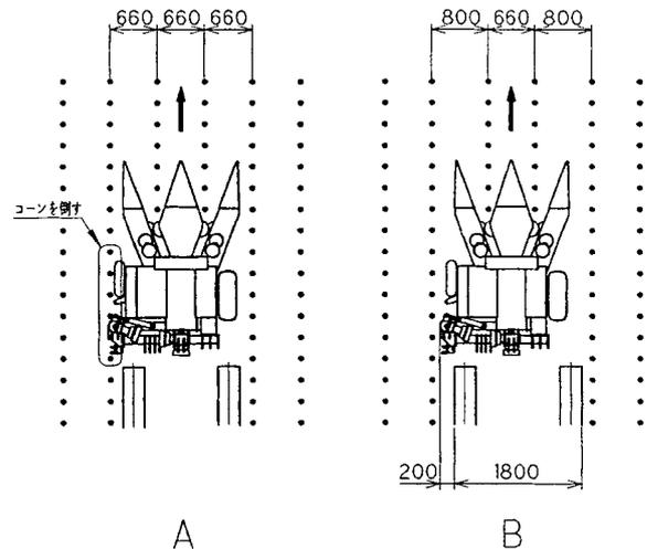
また、トラクタ外幅は1,800mm以下とし、サイド作業時、トラクタと作業機が適正な位置関係になるよう、作業機左側のタイヤがトラクタのタイヤと100mm以上、作業機左側がトラクタのタイヤから200mm以上出るようにマッチングしてください。(C図)
