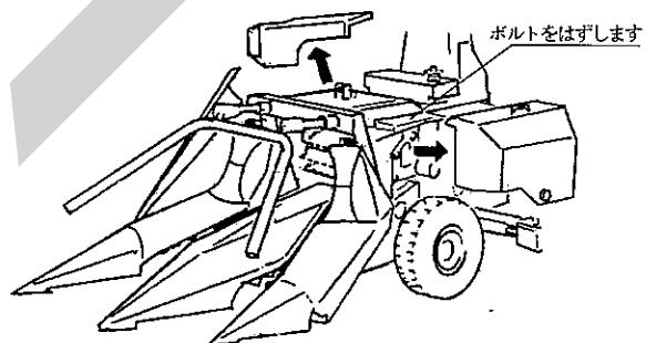
(3) メインフレーム；2の取付けボルト①(両側)及びボルト②をゆるめ、リヤロール駆動のジョイントをはずします。
