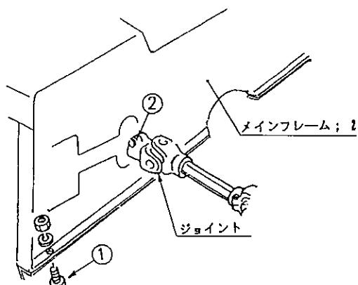
(4) フレーム後方のボトムプレートとダクトをとめているカクネボルトをはずします。
