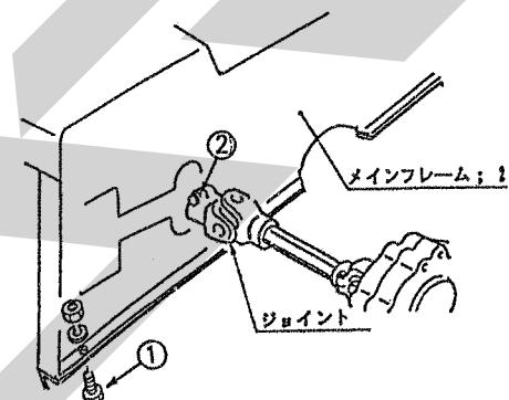
(4) フレーム後方のボトムプレートとダクトをとめているボルトをはずします。
