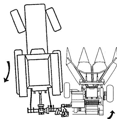
**取扱い上の注意** 時、トラクタのタイヤ(前輪)とアタッチメントの距離を確認しながら油圧操作してください。
