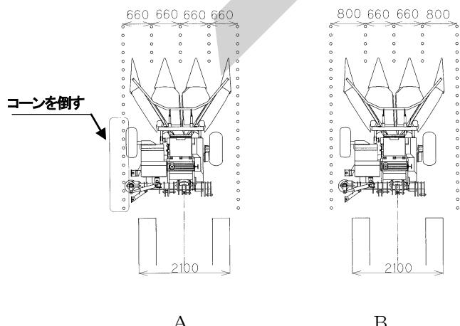
また、トラクタ外幅は、2100mm以下とし、サイド 作業時、トラクタと作業機が適正な位置関係になるよ う、作業機左側のタイヤがトラクタのタイヤと 150m m以上出るようにマッチングしてください。
