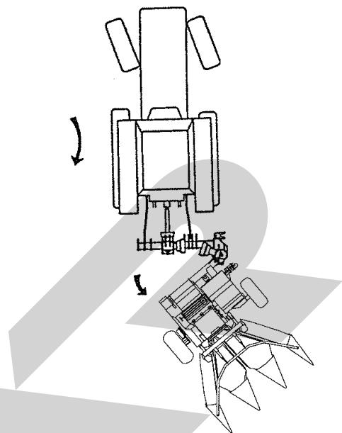
(3) 本体とフレームが 90° 開いたら、トラクタの外部油圧を旋回用シリンダが伸びる方向に操作しながら、サイド状態になるまでバックします。
