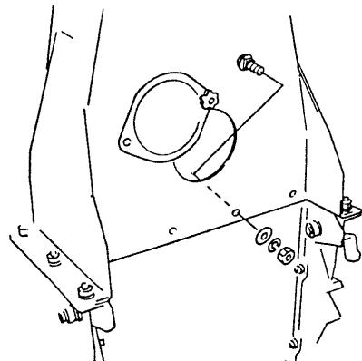
(5) ボルト、ナットを外して、トップマストを外してください。
