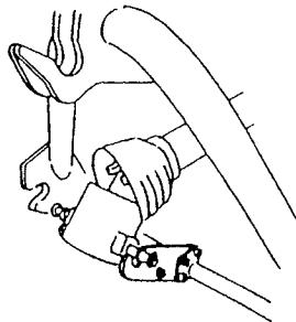
(6) オートヒッチフレーム上部ガイド（フック部）がトップリンク部をすくい上げができる位置までトラクタをフレールモアを中心に向けて、ゆっくりバックさせます。
