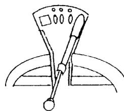
3. トラクタを左旋回前進させて、ストップブラケットをロックさせます。
