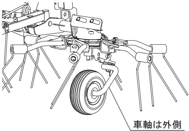
(4) サブフレームCP;L(R)にアームCP;L(R)をデルタピンにて取り付けます。
