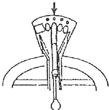
3. トラクタを前進させて、スイングロックレバーをロックさせます。
