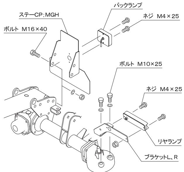
(6) リアランプ取付部のコードには、右ラベルがあります。機体進行方向と合うように組付けください。トラクタ側のコードが長い場合はリピートタイで結束してください。
