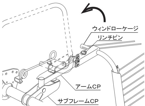
2. トラクタ座上より、ストップパイプを押し下げ回し、ストップブラケットを運搬状態の穴位置に入れます。
