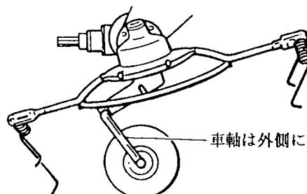
(4) サブフレームにアーム；L・Rをデルタピンにて取り付ける。
