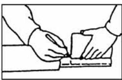
(3) パイプのアウタとインナ両方を金ノコまたはカッターで切断します。
