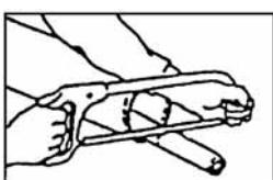
切断するときは、パイプの中にウエスを詰め、パイプ内面に切り粉が付着するのを防いでください。
