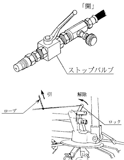
2. トラクタ油圧（外部取出）を操作し、ロータを広げてください。
