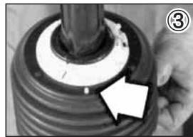
③アウターコーンを取り付、コーンの穴にベアリングリングの基準ピンを挿入します。
