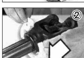
②基準ピンをドライブチューブに向けて、ベアリングリングを溝に取り付けます。
