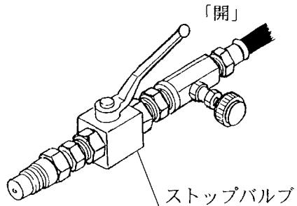
5. トラクタ油圧（外部取出）を操作し、ロータを折りたたみます。
