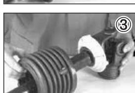
③アウターコーンとベアリングリングを取り外します。
