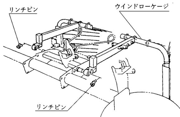
④ スプリングをフレームに固定します。
