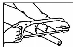
切断するときは、パイプの中にウエスを詰め、パイプ内面に切り粉が付着するのを防いでください。
