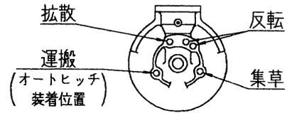
**作業位置** 各作業機に合わせてロックピンをセットしてください。
