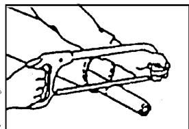
切断する時は、パイプの中にウエスを詰め、パイプ内面に切り粉が付着するのを防いでください。
