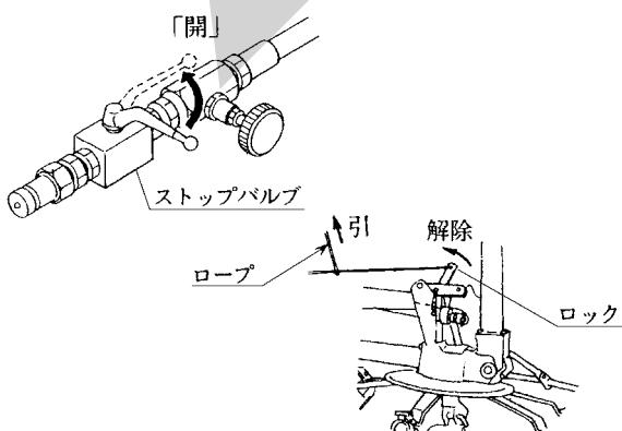
2. トラクタ油圧（外部取出）を操作し、ロータを広げてください。
