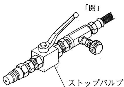
3. トラクタ油圧（外部取出）を操作し、ロータを折りたたみます。
