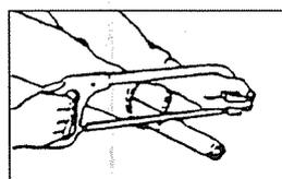
切断する時は、パイプの中にウエスを詰め、切り粉がパイプ内面に付着するのを防いでください。
