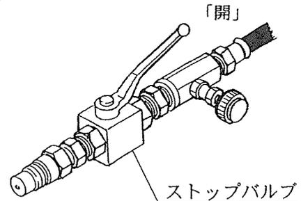
3. トラクタ油圧（外部取出）を操作し、ロータを折りたたみます。
