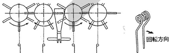
(2) 反射パネルは下図の向きに取付けてください。
