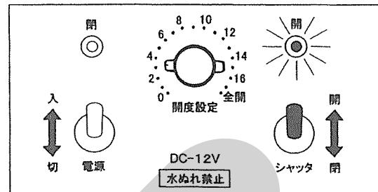
(4) シャッターを閉じるときは、開閉スイッチを「閉」にします。このときチェックランプの「閉」が点滅します。動作が完了するとチェックランプの「閉」が点灯します。
