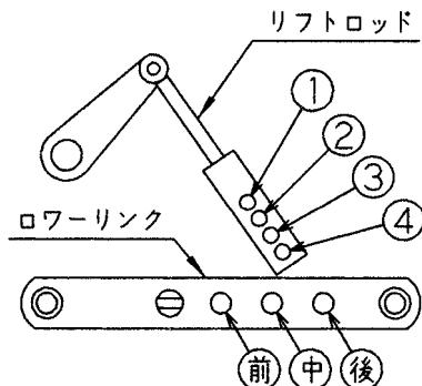
3点リンク最上時、シャッタ開閉レバーがトラクタに干渉するものがあります。純正ロータリ用ヒッチ以外で本作業機を装着する場合は、リフトロッド穴を4(最下)、ロワーリンク穴を後で装着してください。
