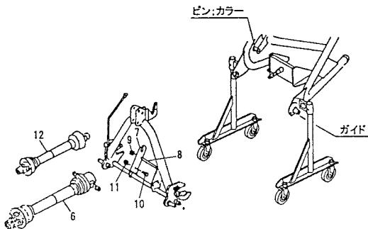
(6) ロワーリンクの地上高が40cm位で、オートヒッチフレームの姿勢が後傾 5° 位になるようにトップリンクの長さを調整してください。
