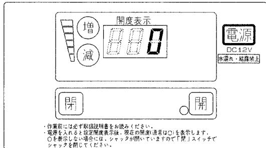
(2) 「増」ボタンまたは「減」ボタンを押して決められた開度に設定してください。長押しすることで高速設定できます。1～36（全開）まで設定できますが、開度ラベルに基づいた条件で設定してください。
