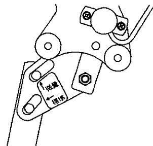
（例）石灰（粉状肥料）を10アール当たり150kg散布したい場合、トラクタ車速8km/hrで開度13にストップをセットします。（手動開閉）
