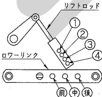
3点リンク最上時、シャッタ開閉レバーがトラクタに干渉するものがあります。純正ロータリ用ヒッチ以外で本作業機を装着する場合は、
