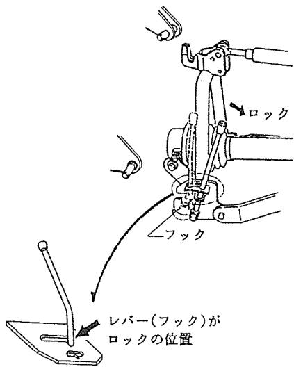
(8) PIC軸芯がトラクタ中心におおよそ一致するよう、チェックチェーンでセットし、作業機の横振れをなくしてください。
