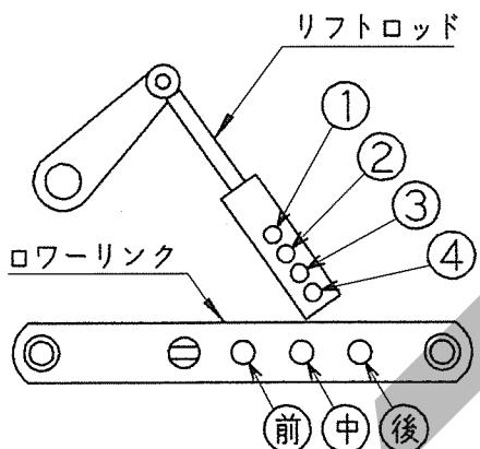
3点リンク最上時、シャッタ開閉レバーがトラクタに干渉するものがあります。純正ロータリ用ヒッチ以外で本作業機を装着する場合は、リフトロッド穴を4（最下）、ロワーリンク穴を後で装着してください。
