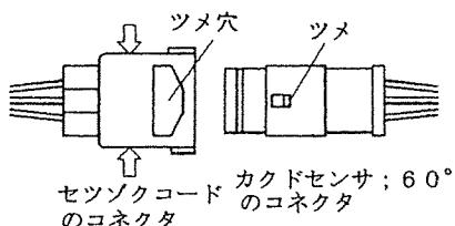
(6) セツゾクコードの2Pコネクタ（T字、コード色 白・黒）とコード；3500（電源コード）又はトラクタ内の電源に取付けてください。
