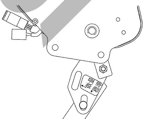
(13) レバーCPとフレームを固定しているボルト、カラー、ナットを外してください。（外したボルト、カラー、ナットは不要です）
