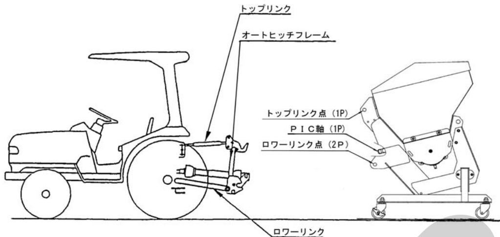
(3) J I S規格により、トラクタ3Pの寸法が規定されており、「0・I兼用」タイプと「I・II兼用タイプ」があります。オートヒッチにもこの2種類があり、一般的に「0・I兼用タイプ」は「S」、「I・II兼用タイプ」は「L」で区分しています。
