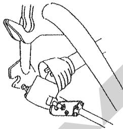
(7) オートヒッチフレーム上部ガイド(フック部)がトプリック部をすくい上げることができる位置までトラクタをフレールモーア中心に向けて、ゆっくりバックさせます。
